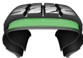
ベルト (タイヤの補強帯)
